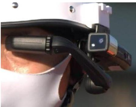
スマートグラスに搭載されたカメラで映像を撮影し、部隊内で共有できます。カメラのON/OFFは遠隔操作も可能なため、隊員は作業を中断せずに現場に集中できます。
